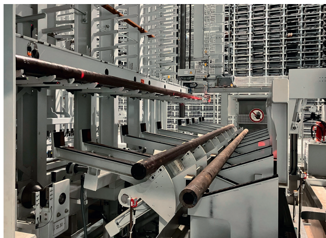
3 Die Ausgabestation 'KastoPick split' vereinzelt das Langgut über Aushubmimiken und übergibt es an die Zufuhrrollenbahn der Säge © Kasto
