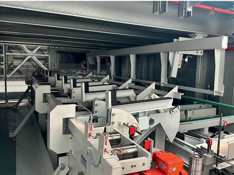
4 Mit der Säge- und Lagerlösung fertigt SEW ab Losgröße 1 vollautomatisch © Kasto
