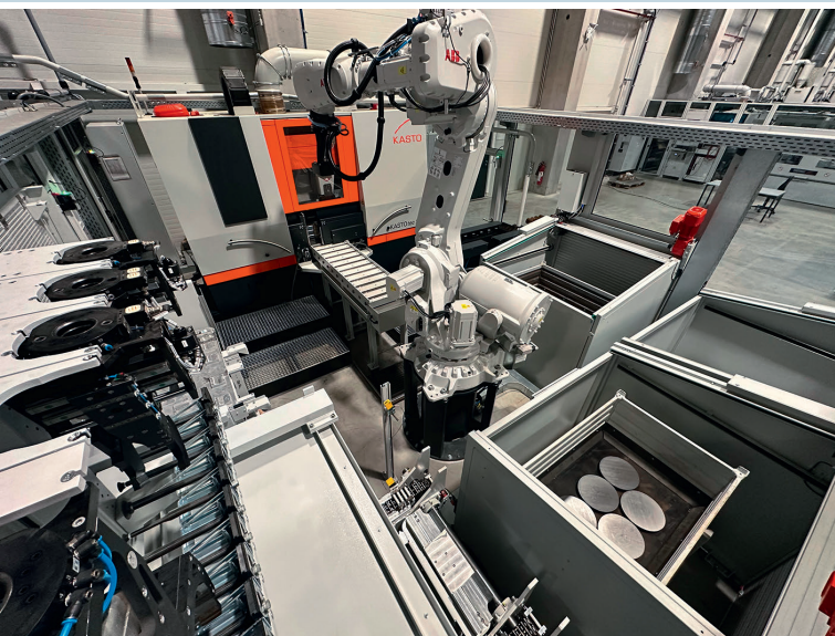
2 Der vollhydraulische Hochleistungs-Bandsägeautomat KastoTec SC 4 zerteilt Rohre und Stangen mit großen Querschnitten in Einzelstücke © Kasto
