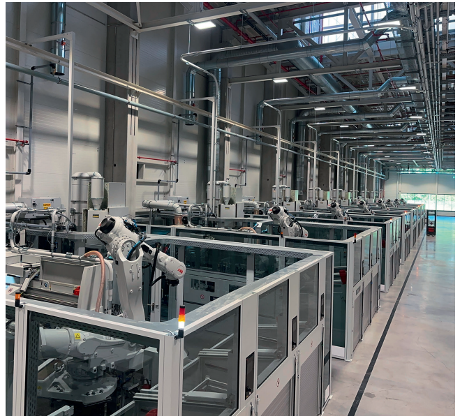
5 Acht vollautomatische Produktionskreissägen des Typs Kasto-Variospeed C 18 durchtrennen Werkstücke bis 180 Millimeter Durchmesser © Kasto
